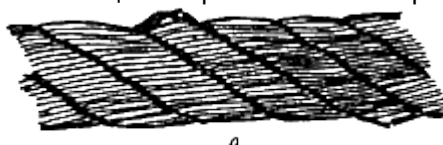
Рис.1. Обрывы и смещения проволок каната крестовой свивки
