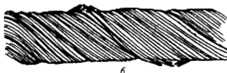
Рис.2. Сочетание обрывов проволок с их износом:
