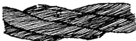
Рис.1. Обрывы и смещения проволок каната крестовой свивки
