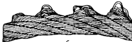
Рис.5. Выдавливание проволок прядей: а - в одной пряди; б - в нескольких прядях
