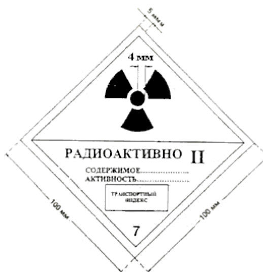
Рис.3. Этикетка категории "II - ЖЕЛТАЯ". Цвет фона верхней половины этикетки - желтый, нижней половины - белый, цвет основного знака радиационной опасности (трилистника) и надписей - черный, цвет полос, обозначающих категорию, - красный
