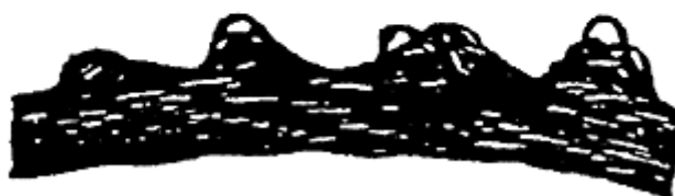
Рис. 11. Выдавливание проволок прядей: а - в одной пряди; б - в нескольких прядях
