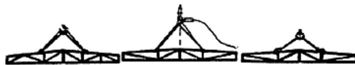
Строповка арочной фермы балансирной траверсой
