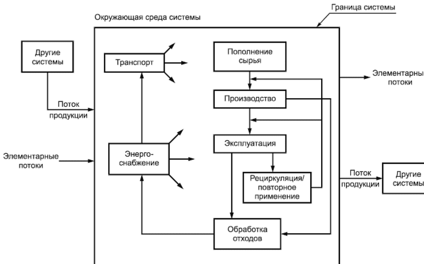
Рисунок 2 - Пример производственной системы для ОЖЦ
