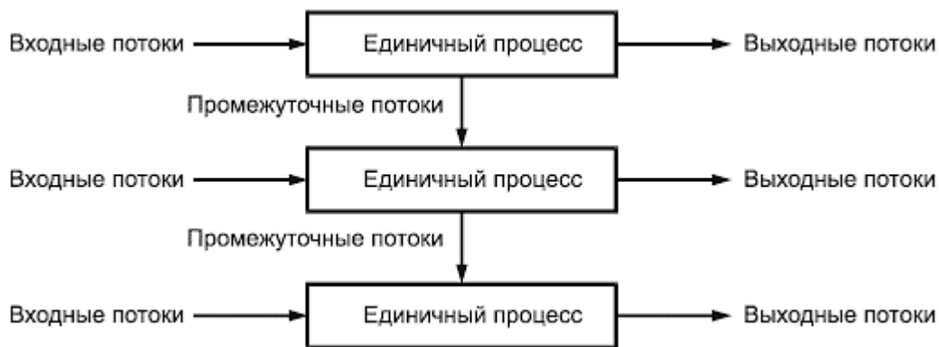
Рисунок 3 - Пример ряда единичных процессов в рамках производственной системы
