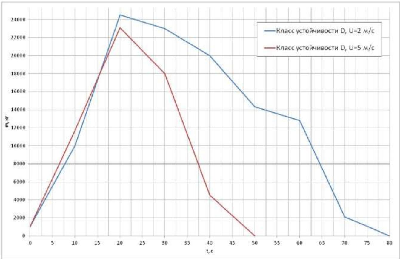
**Рисунок 6-2.** Примеры изменения массы облака между  $S_{ВКПР}$  и  $S_{НКПР}$  при дрейфе в условиях изотермии со скоростями ветра 2 и 5 м/с
