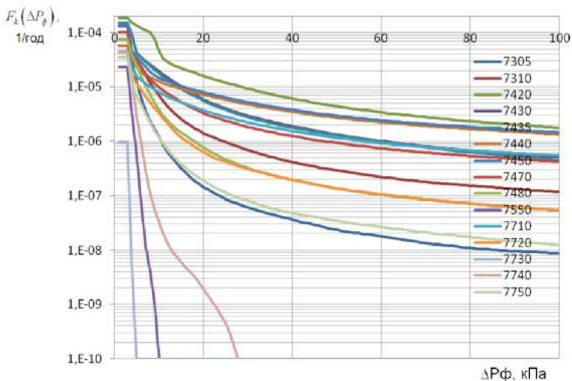
**Рисунок 6-6.** Зависимости частоты  $F_k$  превышения избыточного давления  $\Delta P_\phi$  на фронте ударной волны для различных зданий от величины  $\Delta P_\phi$ . Результаты оценки показателей риска разрушения различных зданий с учетом их удаленности от источников аварии и проектного давления  $P_{пр}$  представлены в [таблице N 6-6](#) и на [рисунке 6-6](#) приложения N 6 к настоящему Руководству.
