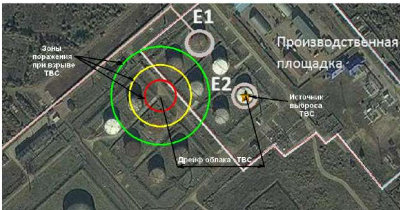
Рисунок 5- 1. Зоны поражения ударной волной при взрыве облака ТВС
