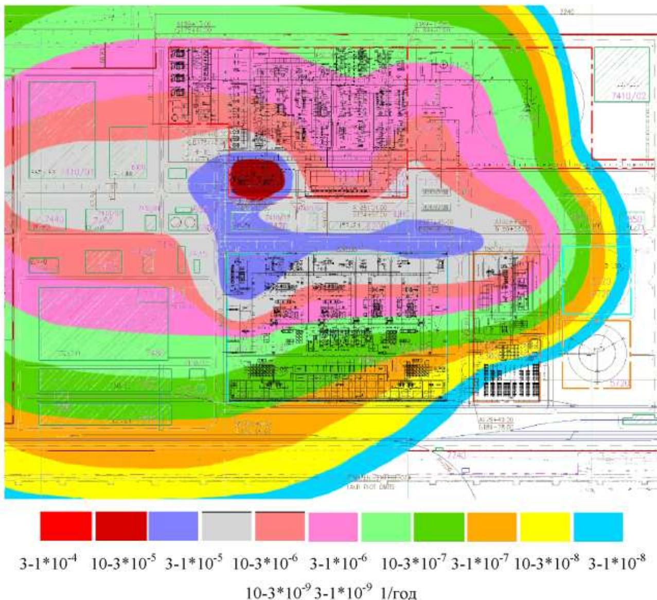
**Рисунок 6-5.** Территориальное распределение потенциального риска разрушения зданий при  $\Delta P_{\text{ф}} = 28$  кПа при авариях на всех установках и системе трубопроводов со взрывом облака ТВС.
