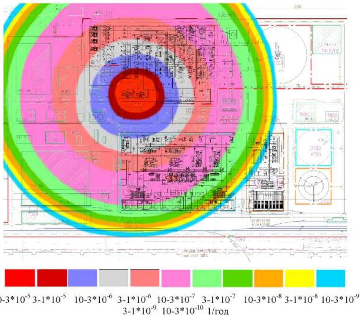
**Рисунок 6-3.** Территориальное распределение потенциального риска разрушения зданий при  $\Delta P_{\phi}=12$  кПа при авариях на деэтанализаторе со взрывом облака ТВС
