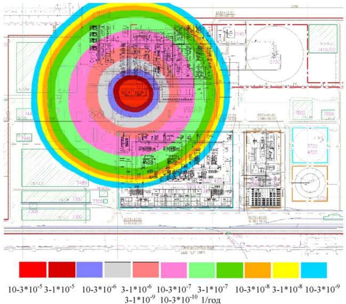
**Рисунок 6-4.** Территориальное распределение потенциального риска разрушения зданий при  $\Delta P_{\phi}=28$  кПа при авариях на деэтанализаторе со взрывом облака ТВС
