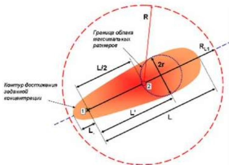
**Рисунок 3.** Схема распространения первичного и вторичного облаков ТВС при аварийном выбросе вскипающих жидкостей
