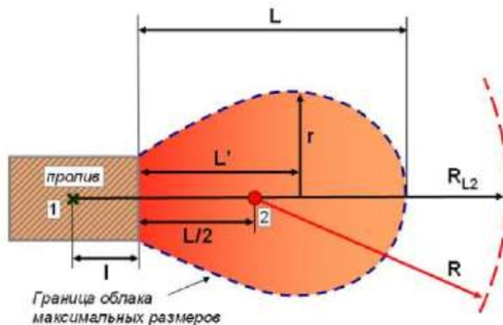
**Рисунок 4.** Схема распространения вторичного облака ТВС при аварийном выбросе и испарении из пролива стабильных жидкостей
