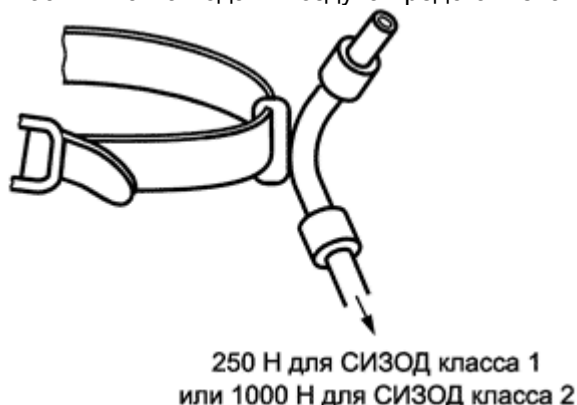
Рисунок 6 - Схема испытания прочности шланга подачи воздуха
