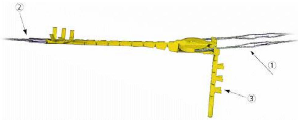
1 - провод; 2 - протягиваемый трос; 3 - хвостовик
