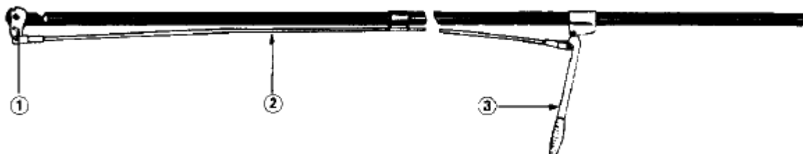
1 - режущая головка; 2 - тяга; 3 - рычаг управления
