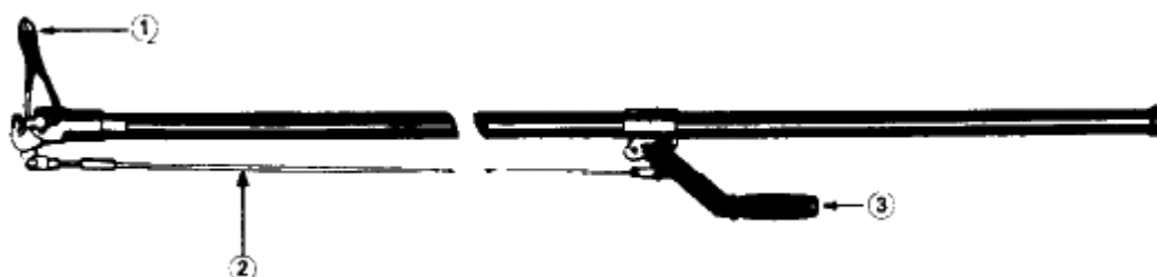
1 - кусачки; 2 - тяга; 3 - рычаг управления
