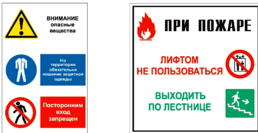
Рисунок 9 - Примеры выполнения групповых знаков безопасности Цвет поверхности прямоугольного блока групповых знаков - белый.
