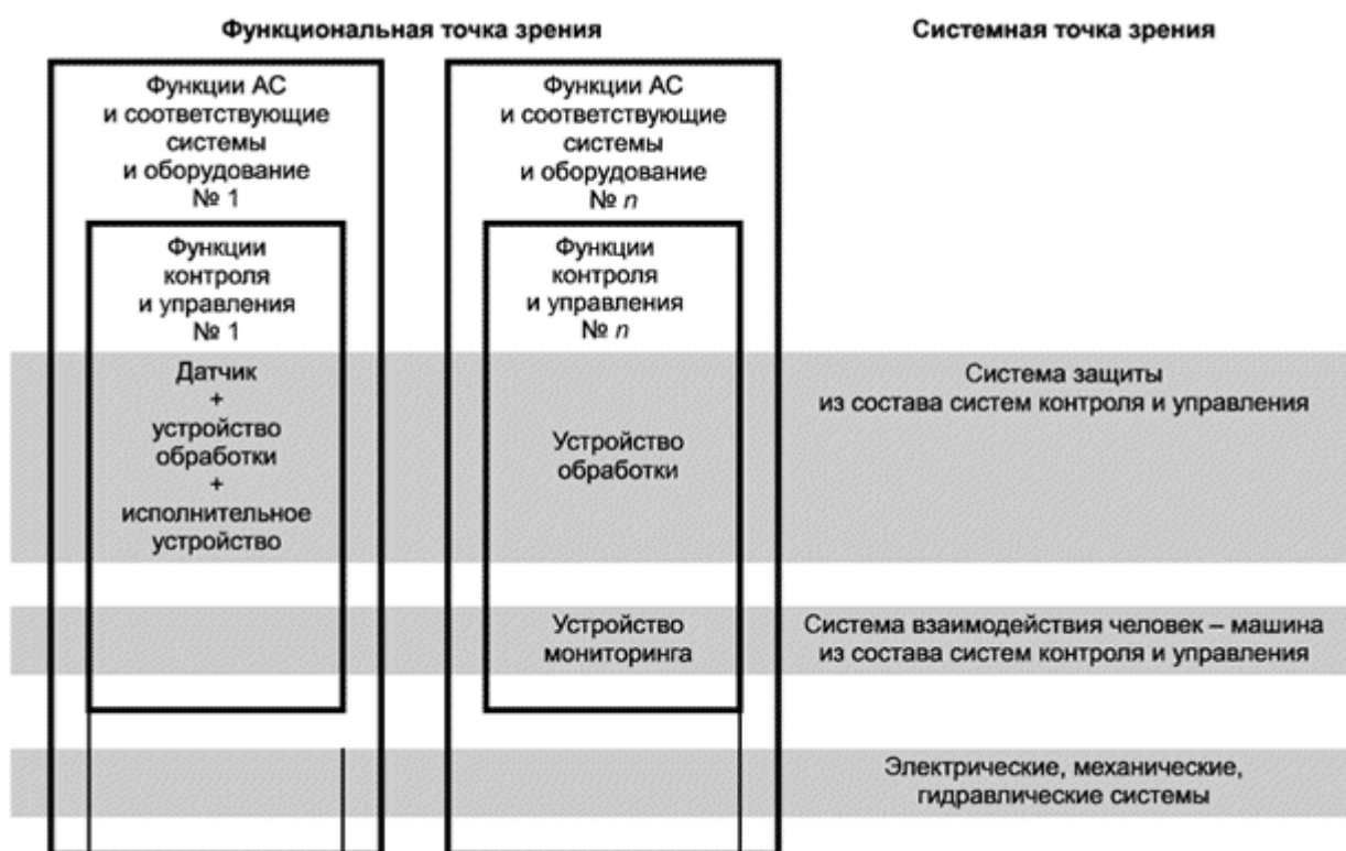
Рисунок В.1 - Отношения между функциями и системами контроля и управления АС
