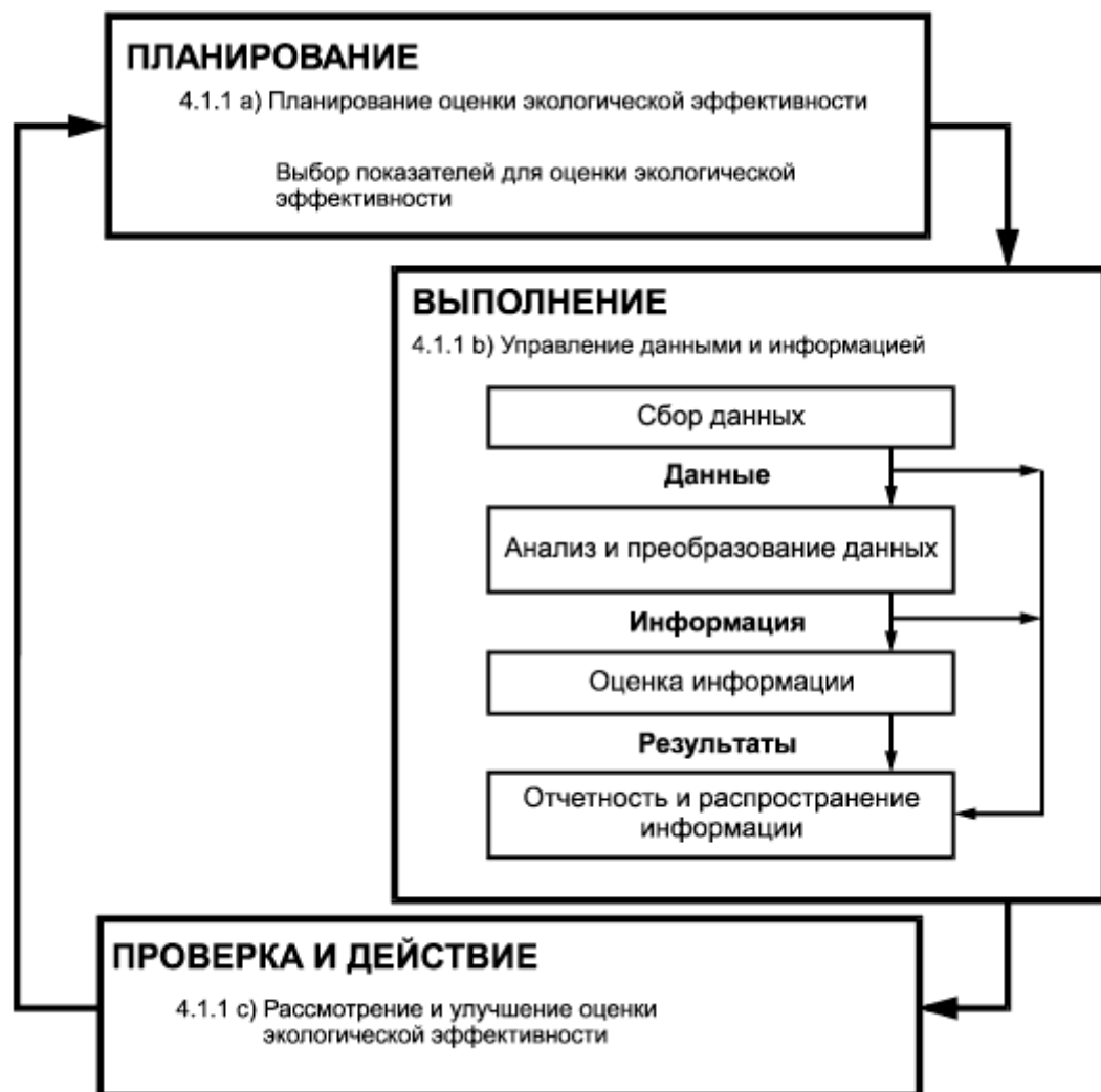
Рисунок 2 - Схема ОЭЭ (согласно модели PDCA)
