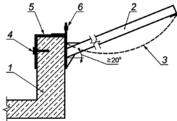
1 - стена (подоконник); 2 - опора из труб; 3 - сетка; 4 - анкеры для прикрепления устройства 5 к стене; 5 - устройство для прикрепления опоры к стене; 6 - место прикрепления опоры к устройству 5
