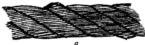
Рисунок 1. Обрывы и смещения проволок каната крестовой свивки
