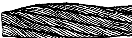
Рисунок 13. Местное увеличение диаметра каната
