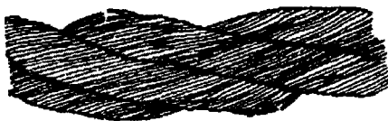
Рисунок 1. Обрывы и смещения проволок каната крестовой свивки
