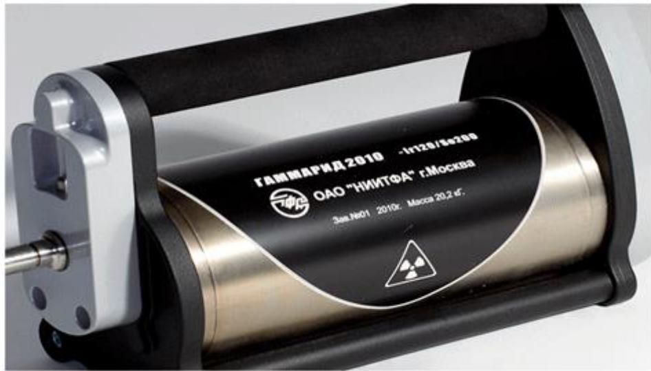
Рассмотрим пример категорирования радионуклидного гамма-дефектоскопа серии "Гаммариd 2010", в состав которого входит закрытый радионуклидный источник излучения на основе Ir-192 с активностью 200 Ки (1 Ки (Кюри) =  $3,7 \cdot 10^{10}$  Бк) на этапе транспортирования.
