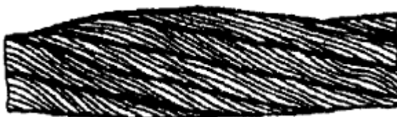
Рисунок 13. Местное увеличение диаметра каната.
