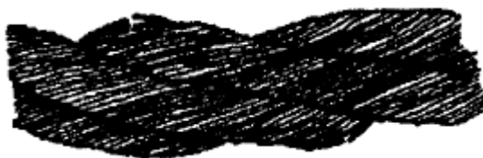
Рисунок 1. Обрывы и смещения проволок каната крестовой свивки.
