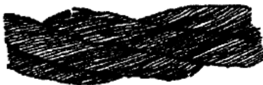
Рисунок 1. Обрывы и смещения проволок каната крестовой свивки.
