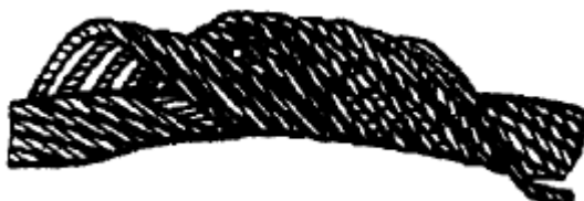
Рисунок 9. Местное уменьшение диаметра каната на месте разрушения органического сердечника.
