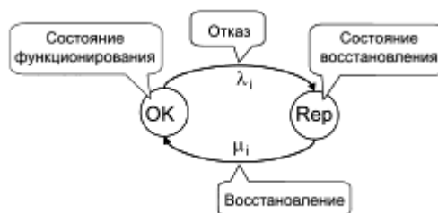
Рисунок 22 - Граф Маркова коэффициента готовности для простого восстанавливаемого блока
