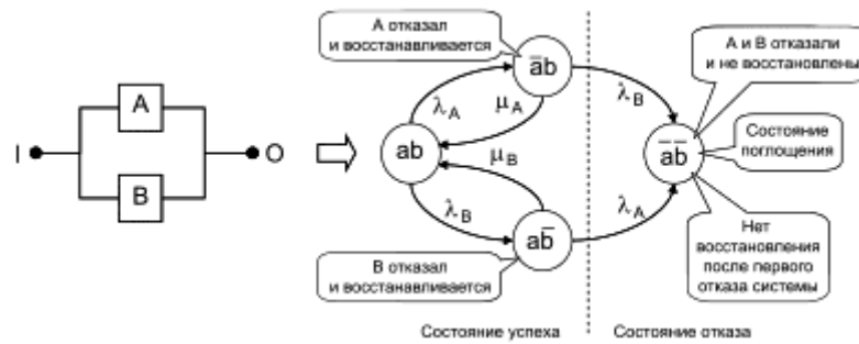
Рисунок 27 - RBD и эквивалентный Марковский граф для расчетов вероятности безотказной работы Теперь уже невозможно рассчитать вероятность безотказной работы системы путем объединения отдельных вероятностей успеха блоков.
