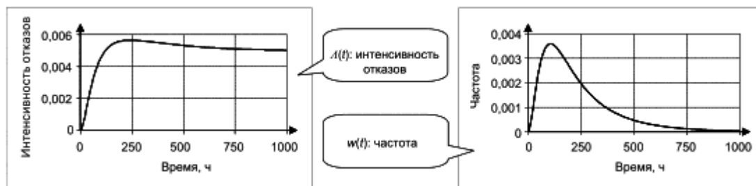
Рисунок F.7 - Интенсивность отказов и частота отказов, соответствующие рисунку F.6
