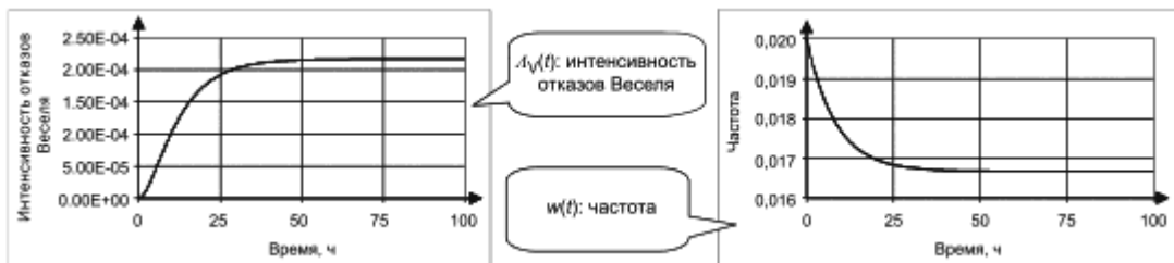
Рисунок F.9 - Интенсивность отказов Веселя и частота отказов, соответствующие рисунку F.8
