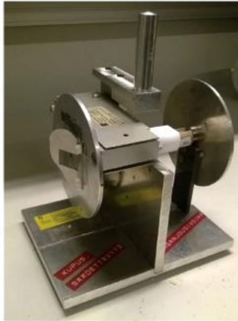
Рисунок 7 - Пример монтажного приспособления с установленными моделями уха по рисункам 10 и 11 для противошумных наушников с оголовьем поверх головы
