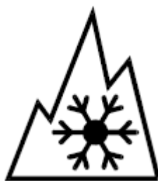
Рисунок 4.3 - Маркировка, наносимая на зимнюю шину
