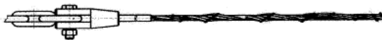
Рис.10. Общий вид канатного анкера типа АК02. Предназначен для ампульно-нагнетательного или нагнетательного закрепления.
