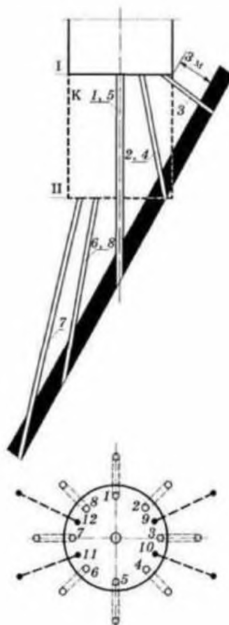
Рисунок 5 – Схема расположения скважин для гидрорыхления угольного пласта крутого залегания:
