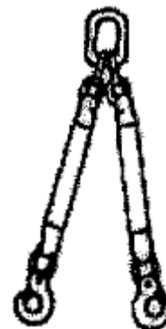
Рис.5. Двухветвевое строповочное устройство
