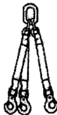
Рис.6. Трехветвевое строповочное устройство
