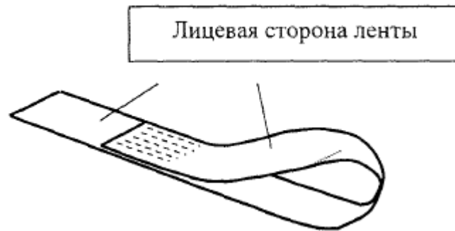
Рис.6. Скрученная петля стропа.
