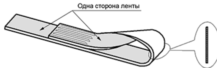
Рисунок 8 - Скрученная петля стропа
