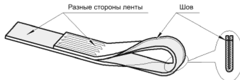
а - петля, сложенная пополам с одной стороны
