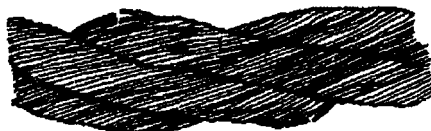
Рисунок 1. Обрывы и смещения проволок каната крестовой свивки
