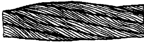
Рисунок 13. Местное увеличение диаметра каната
