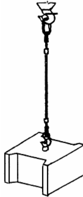
Строп одноветвевой Q = 2,5 тс при монтаже блоков стен подвала P = 0,98 \div 1,97 т
