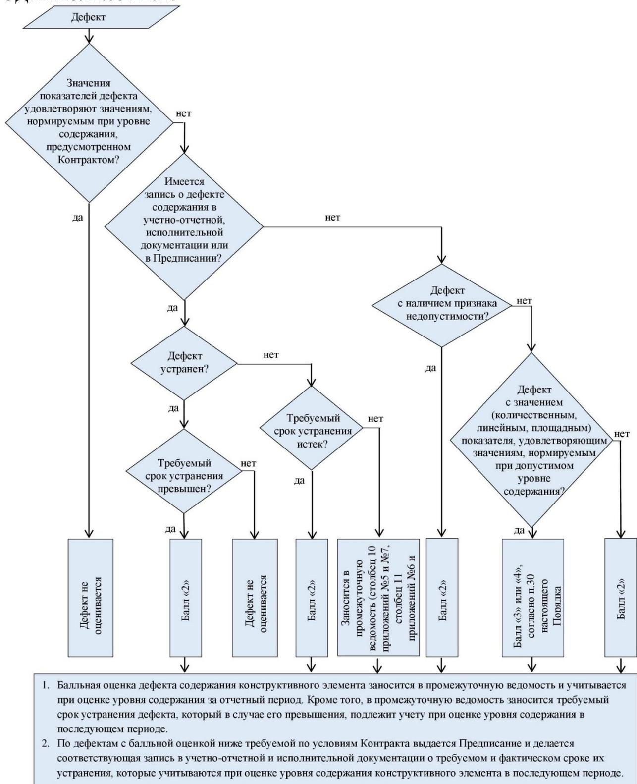
Рисунок 1 - Блок - схема балльной оценки дефекта конструктивного элемента
