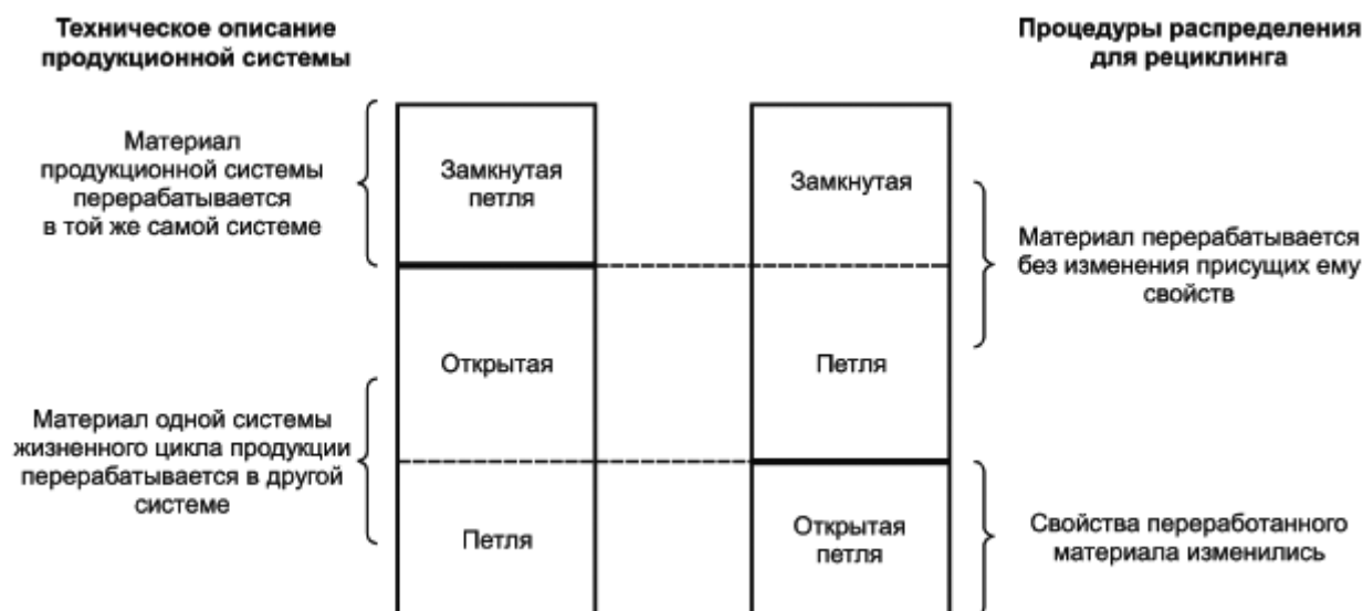
Рисунок 2 - Отличие между техническим описанием производственной системы и процедурами распределения для рециклинга
