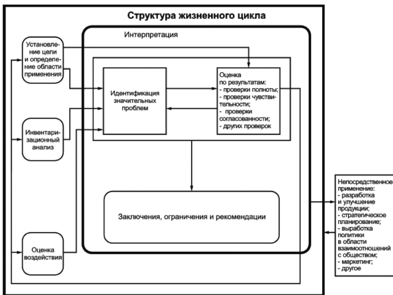
Рисунок 4 - Связь между элементами стадии интерпретации и другими стадиями оценки воздействия жизненного цикла
