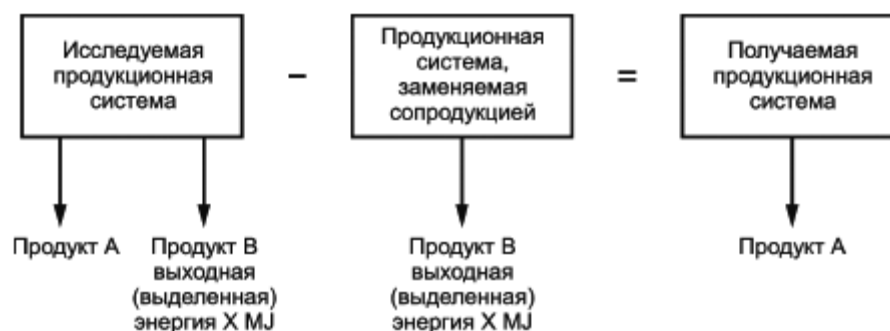
Рисунок D.1 - Пример предотвращения разделения входных/выходных потоков или производственной системы путем расширения ее границ
