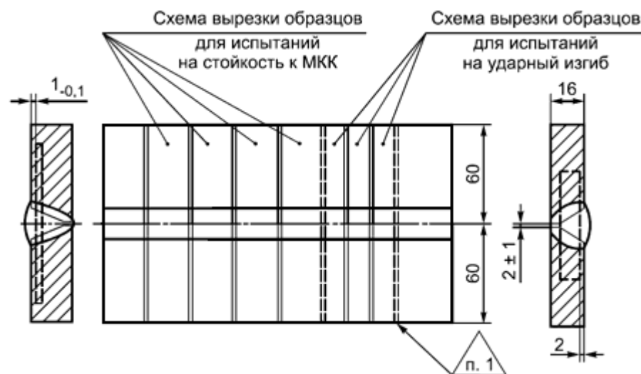
Рисунок В.8 - Контрольное сварное соединение
