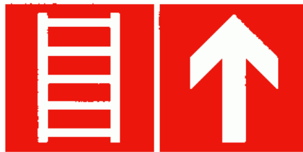
Пожарная лестница вверх
