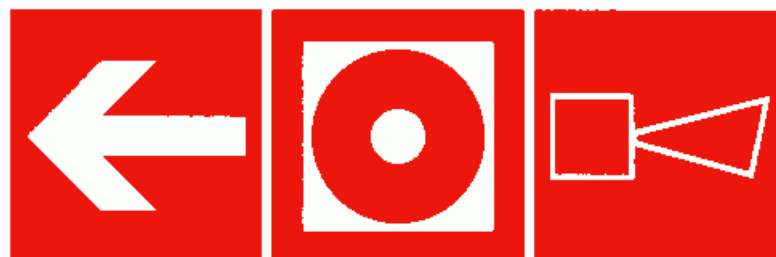
Кнопка включения установок пожарной автоматики и оповещателей налево
