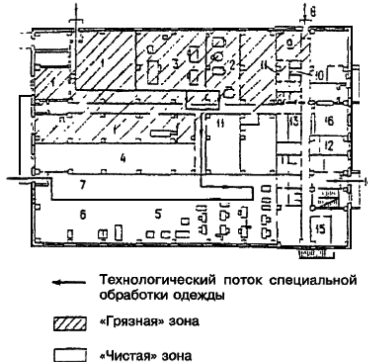
Черт.6. Примерная схема приспособления фабрики химической чистки для специальной обработки одежды
