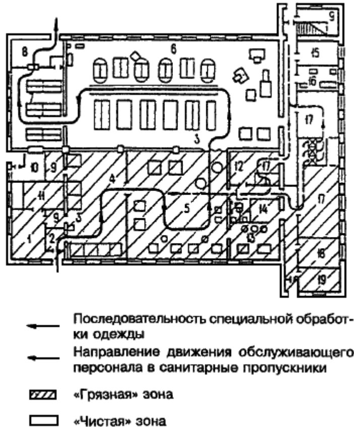
Черт.4. Примерная схема приспособления прачечной для специальной обработки одежды
