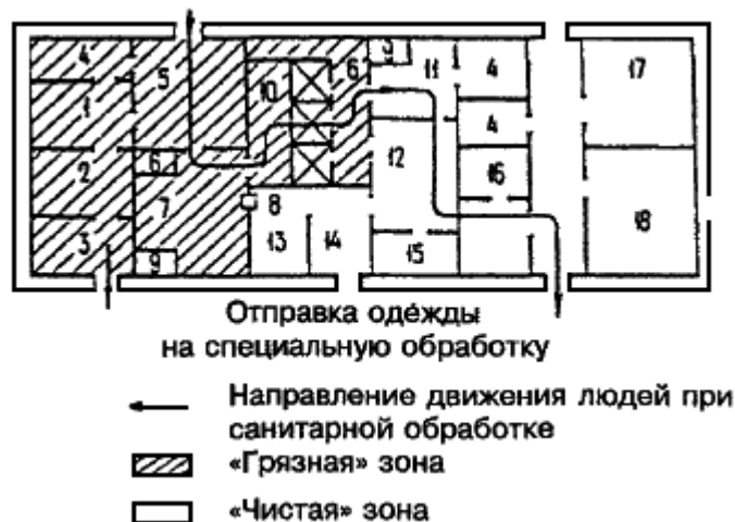
Черт.5. Примерная схема санитарного пропускника на один поток
